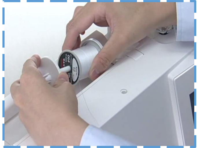
Important de bien accrocher le fil ici pour sentir la tension du fil.
